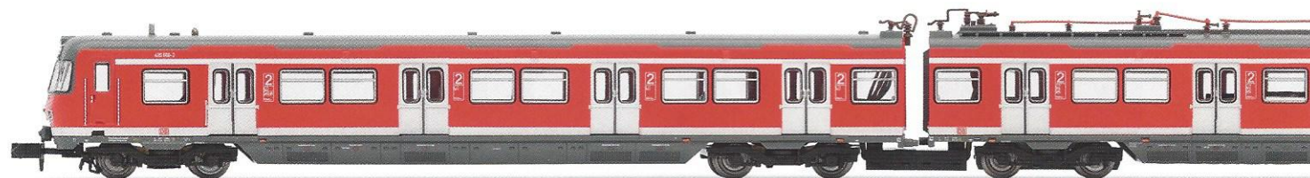
HN2163: Elektrischer S-Bahn-Triebzug, Baureihe 420, in aktueller Farbgebung mit nur einem Stromabnehmer
